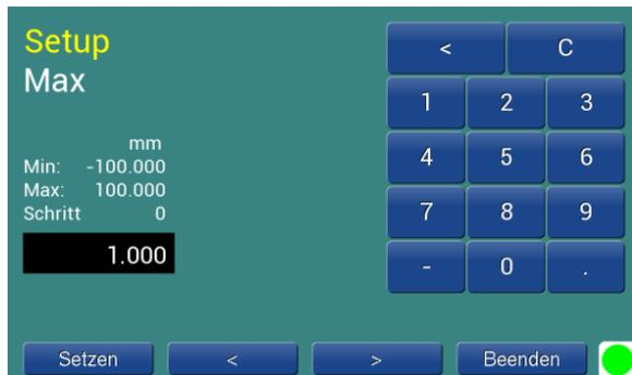
Die numerische Eingabe setzt sich aus den Schaltern **Setzen** / < / > / **Beenden**, einem Zahlenblock und der Parameteranzeige zusammen. Die Bedeutung der Schalter:
