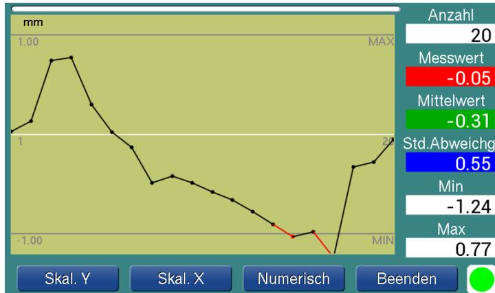
Die automatische Messung wird direkt gestartet. Ein Untermenü mit *Skal. Y / Skal. X / Numerisch / Beenden* steuert die grafische Anzeige oder dient zum Stoppen der Messung.
