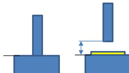
**Verweilzeit** = wie lang der Messtaster auf dem zu Messendem Objekt verweilen soll, bis der Messwert festgehalten wird. (die korrekten Werte sind in den Entsprechenden Normen hinterlegt).
