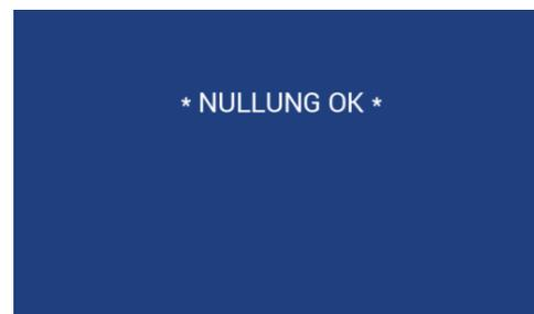
Der Messtaster verfährt mit 2,5mm/sec auf den Messtisch und verweilt dort für 2 sec, bis an dieser Stelle der Messsensor auf "0,000" gestellt wird.
