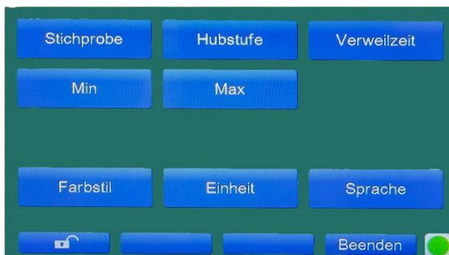
**Stichprobe** = Anzahl der zu messenden Messpunkte (bei Automatik Messung)
